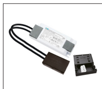
BOKE CC - 100-350mA Dimbar DALI2 + Push Art. nr. BK-DEL010-0350Ad Dip-switch på driver. Settes til 180mA
