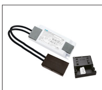
BOKE CC - 100-350mA Dimbar DALI2 + Push Art. nr. BK-DEL010-0350Ad Dip-switch på driver. Settes til 180mA
