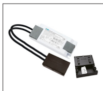
BOKE CC - 100-350mA Dimbar DALI2 + Push Art. nr. BK-DEL010-0350Ad Dip-switch på driver. Settes til 350mA
